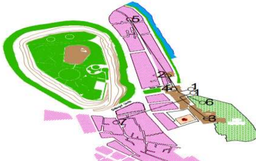
(شكل 6) مخطط مجرى سير القنوات الري لناعورتي توأم الجعبرية ومواقع التغذية المائية استنادا للمعلومات التاريخية
