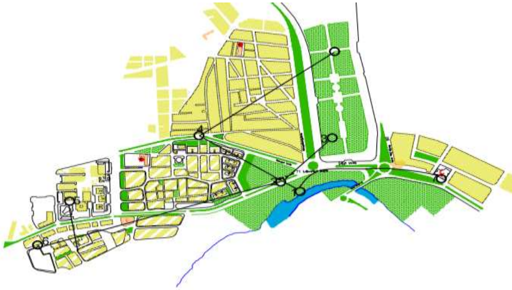
(شكل 1) مخطط سير قنوات الري لناعورة توأم البشريتين ومواقع التغذية المائية استنادا للمعلومات التاريخية
