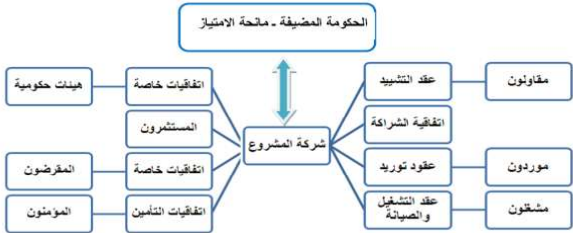
الشكل رقم (1): الهيكل التعاقدى لمشروعات BOT
