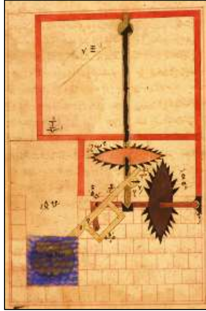
(الشكل 9-أ) آلة رفع المياه الرابعة عند الجزري (عن الجزري، مخطوط معهد التراث العلمي العربي حلب، ورقة 123)
