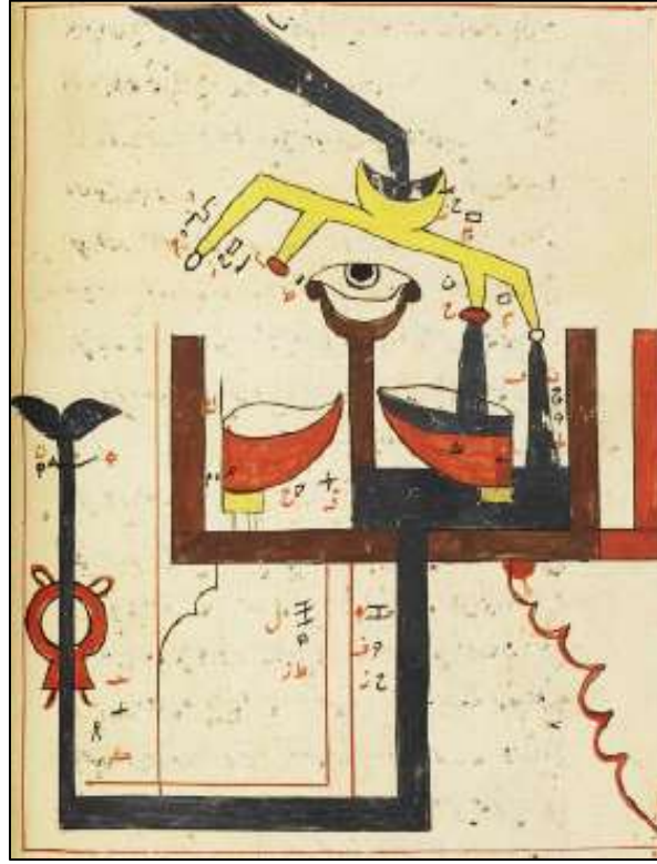
(الشكل 14) فوارة الجزري الأولى ذات الكفتين (تمثل حالة خروج الماء على هيئة قضييب) (الجزري، مخطوط المكتبة البريطانية، ورقة 118ظ)
