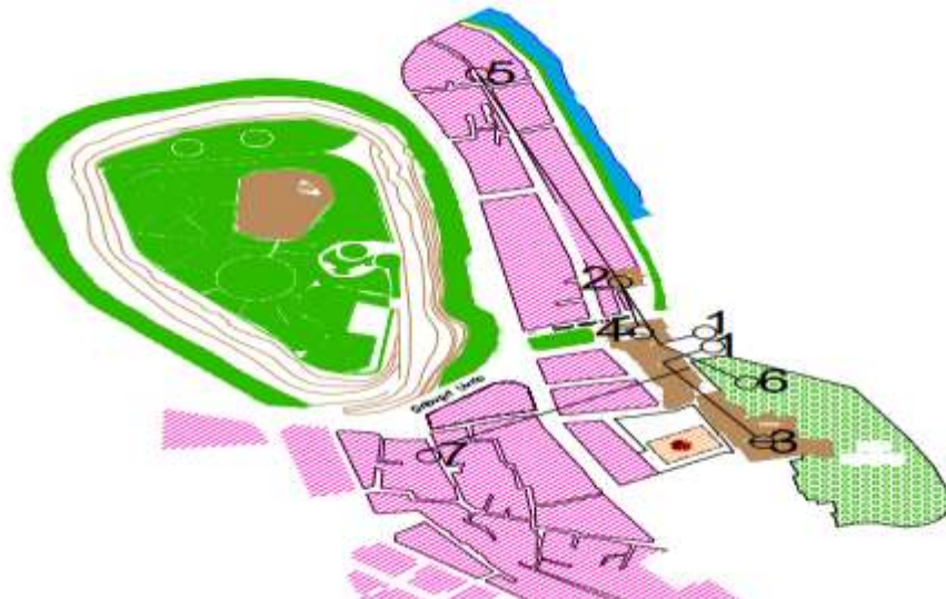
(شكل 6) مخطط مجرى سير القنوات الري لناعورتي توأم الجعبرية ومواقع التغذية المائية استنادا للمعلومات التاريخية
