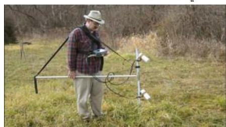
الشكل 3: صورة جهاز المسح المغناطيسي<sup>1</sup> الذي اعتمد في مسح تل الشعيرات.
