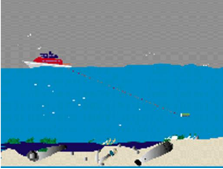
الشكل (3): مسح قاع البحر بطريقة مسبار مغناطيسي
