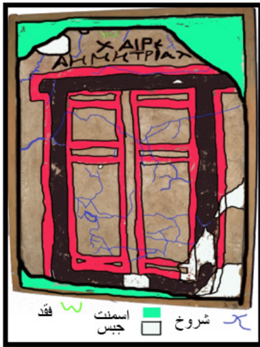
صورة (2) توضح وجود الشروخ والانساختات بجسم اللوحة الأثرية
